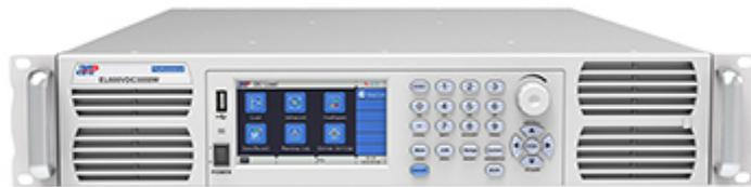
通过 RS232 来实现数据实时监控，通过负载 I-MON 端子来进行大电流保护的验证，提高测试效率的同时也确保了测试的稳定可靠。
