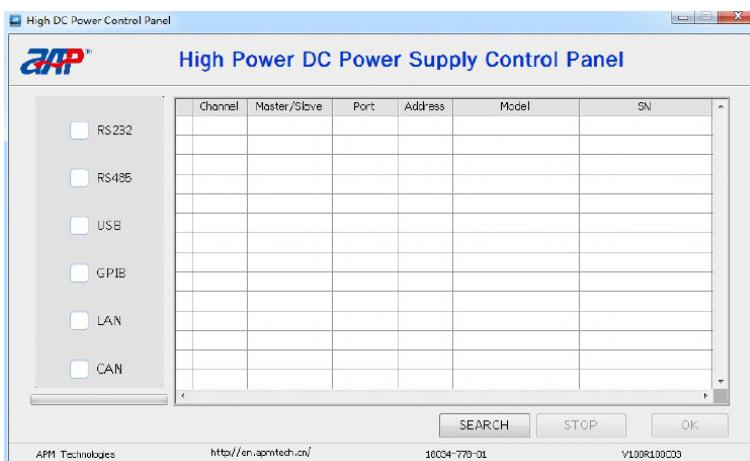
此上位机软件High Power DC Power Supply Control Panel包括RS232、RS485、USB、GPIB、LAN、CAN这6种通讯方式。
